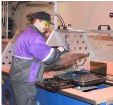
Kuva 4. Kuvaputken eri osien erottelua ja puhdistusta.
